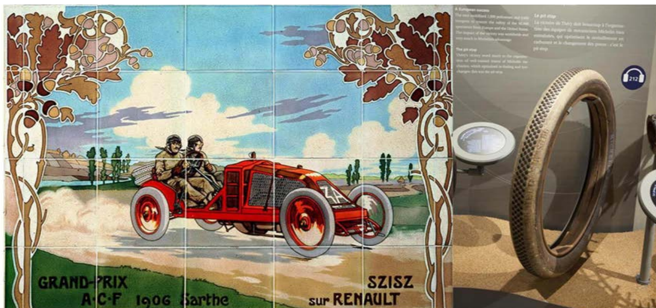
La bande de roulement est garnie de rivets métalliques qui améliorent l'adhérence.
